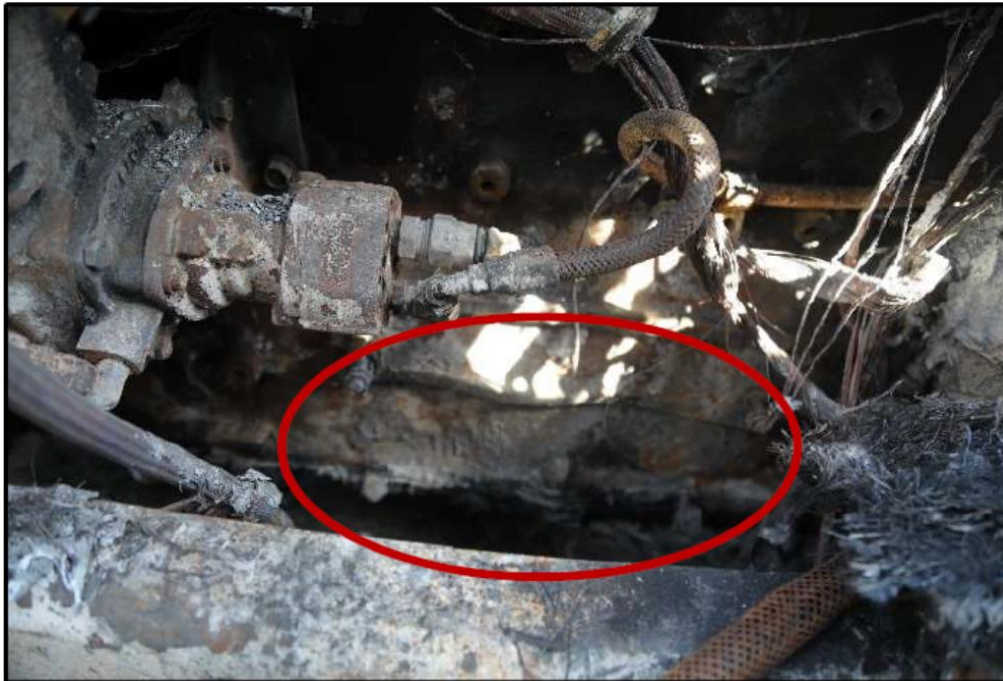
Figure 16. MCE de moteur d'un camion semi-remorque consumé par un incendie après une collision.
