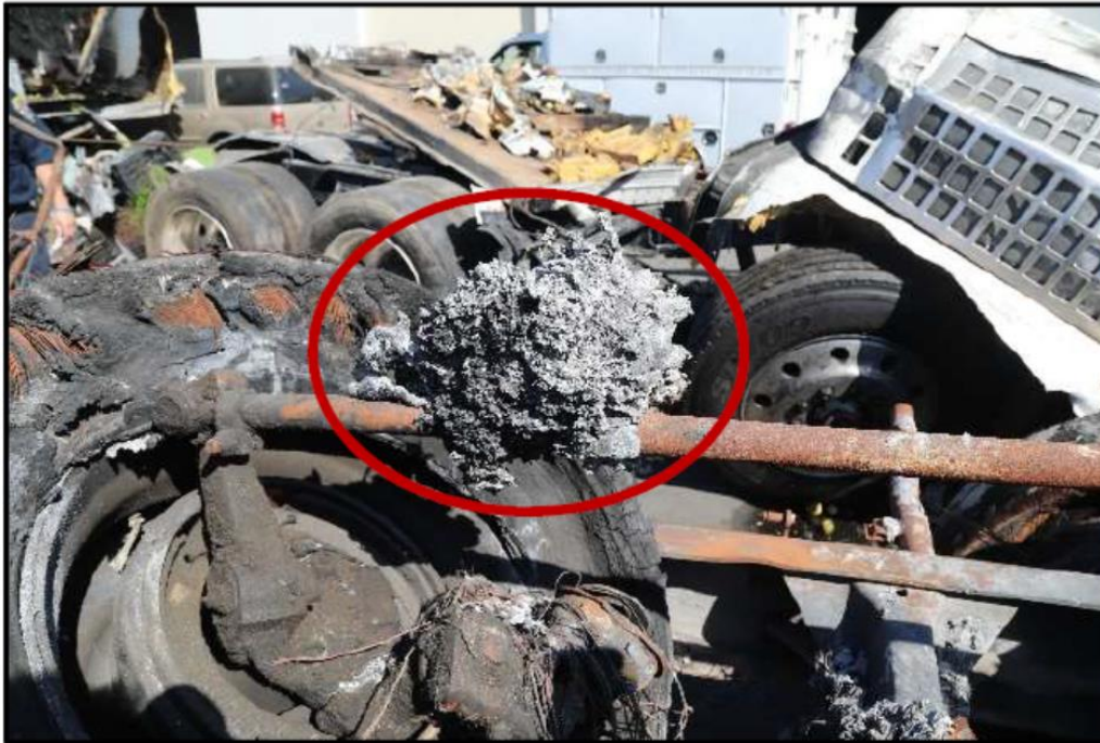
Figure 17. MCE fondu sur la timonerie de direction.
