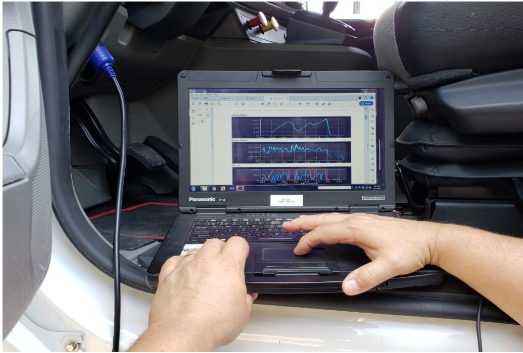
Figure 3. Ordinateur portable connecté au moyen du logiciel PowerSpec de Cummins par le réseau J1939/13.
