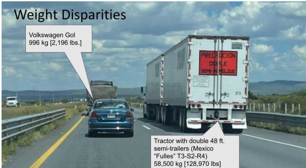
Figure 14. Disparités de poids entre un véhicule léger et un ensemble routier lourd.
