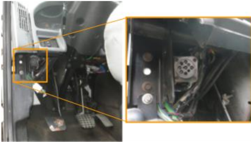
Figure 12. Connecteur Deutsch SAE J1939-13 de type I à neuf broches (noir).
